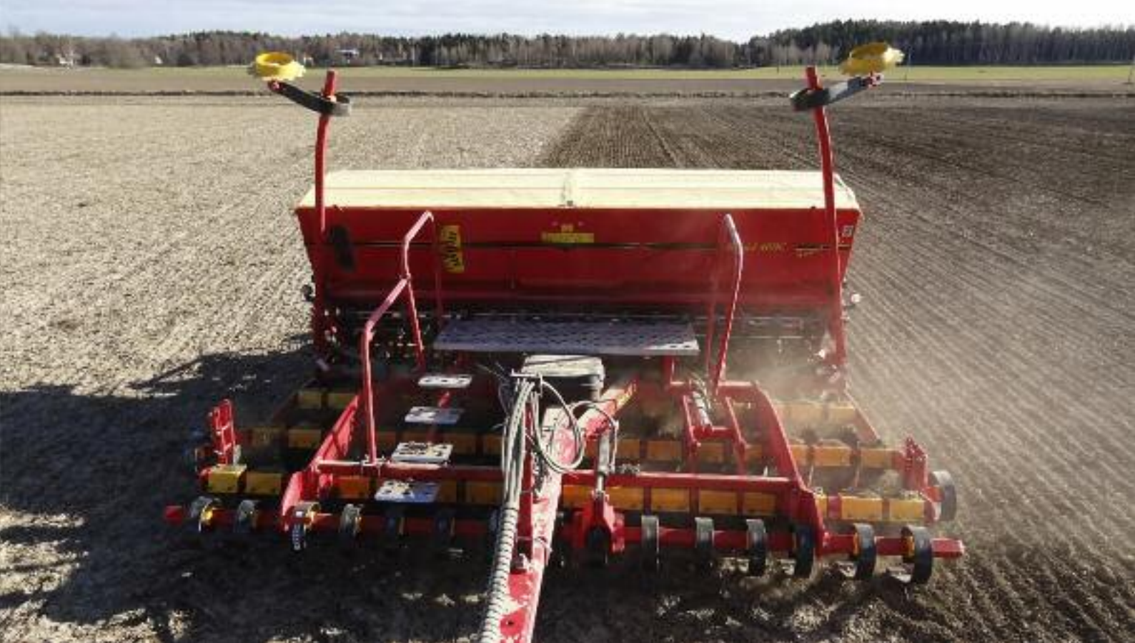
Förredskapet avgör resultatet vid tidig sådd. Här System Disc Aggressive i aktion på jord som inte bearbetats före sådd.
