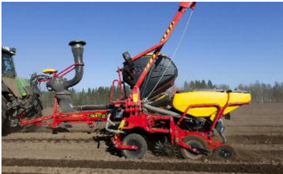
Tempo är konstruerad för precisionssådd i höga hastigheter. Med övertryck i såhusen skjuts majsutsädet ut och fångas upp av det mjuka tryckhjulet som ser till att utsädet får god markkontakt.
