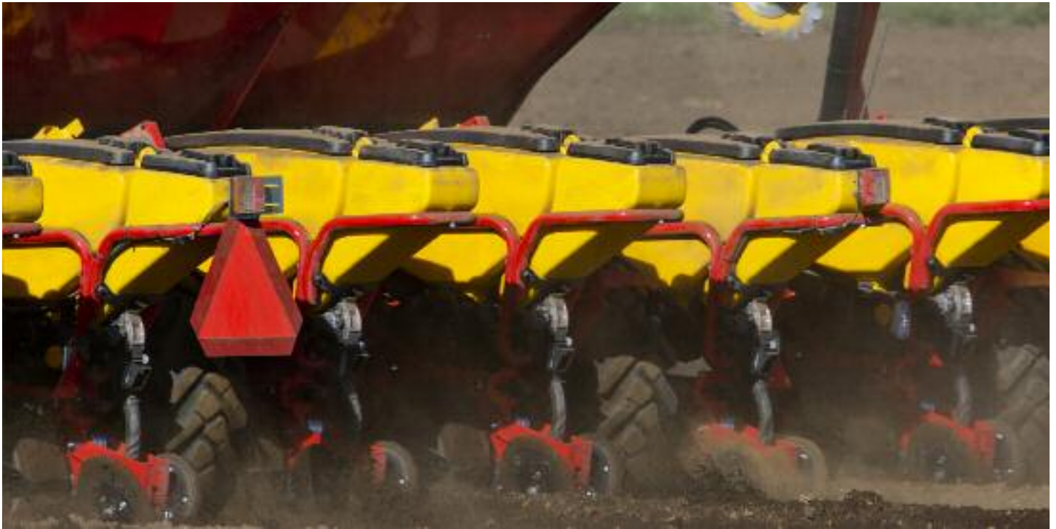
Sålådan på Tempo rymmer 70 liter. På en Tempo F8 med 8 rader räcker utsädet till ca 20 hektar.
