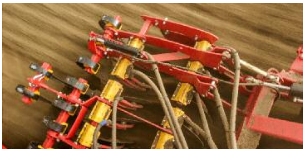
TriForce är en specialutvecklad trekantsbalk med 3 gummistavar som ger god följsamhet, men är stabil i sidled. Väderstads lagring med 4 gummistavar har blivit lite av en standard i branschen, kraftfull med lång livslängd.
