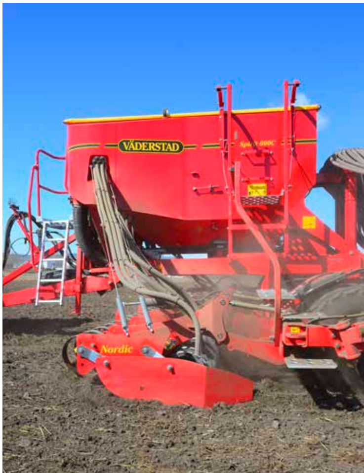
Våren 2015 startade vi också upp många Spirit 600 C med det nya förredskapet Nordic som myllar gödseln på samma sätt som på Rapid – en rad placerad växtnäring var 25:e cm som försörjer två sårader.
