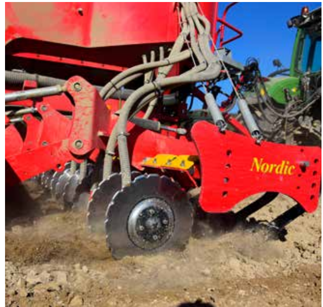
Christer valde Nordie som innebär traditionell radmyllning med placering av växtnäring mellan såraderna.
