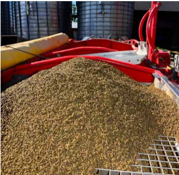
Maskorna i gallren var för små för Biofer från början, men skyndsamt support från Väderstad gjorde att nya galler kom på plats efter några arbetsdagar.
