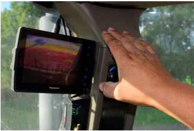
Tre olika eftermonterade kameror gör bra överblick på Rapid-maskinens arbete på en skärm i hytten.
