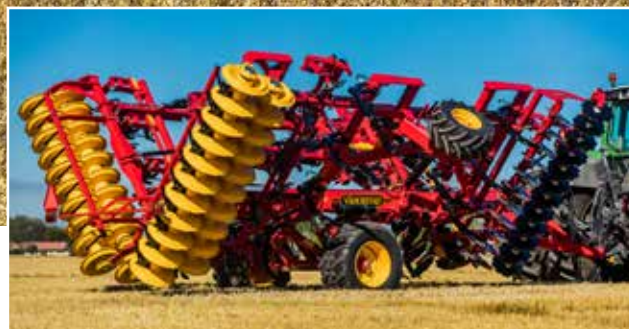
TopDown 300-700 fälls ihop till 3 meters transportbredd.
