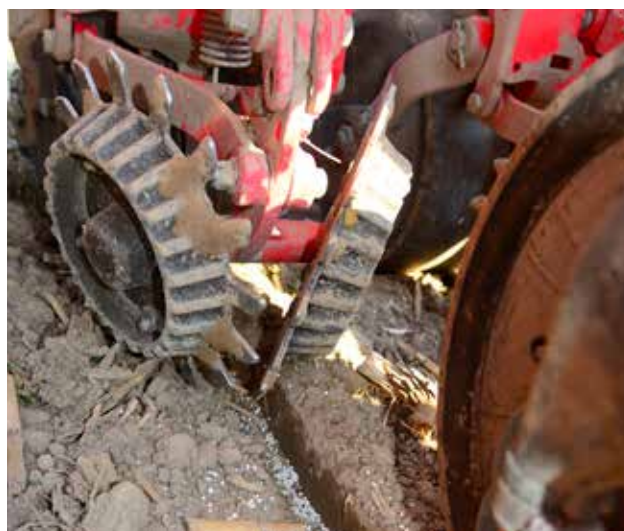
Radrensaren är grejen med Tempo tycker Vicktor. De håller rent från skörderester, sten och jordkakor så att såbilen kan arbeta ostört och placera utsädet exakt.
