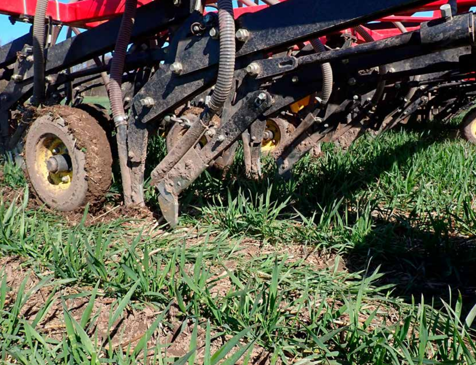
Insådd redan på våren är ett sätt att spara tid. Här en speciallösning där mellangrödan sås mellan raderna i höstvetete som etablerats med 25 cm radavstånd.
