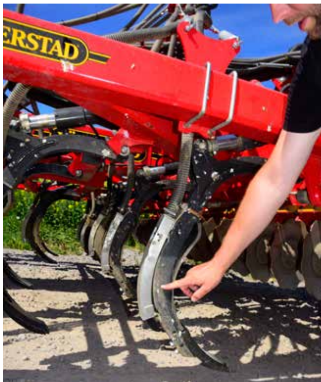
Mineralgödseln landar på två nivåer – både placerad på bearbetningsdjup och myllad på markyta.
