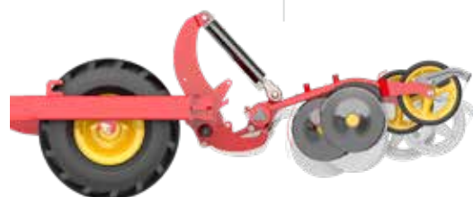
Med en BioDrill kan småfröer sås samtidigt med sädden
