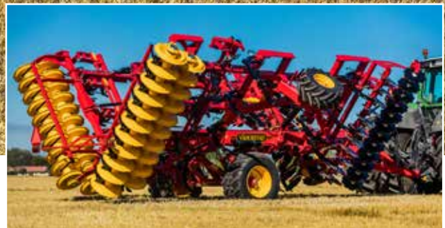
TopDown 300-700 fälls ihop till 3 meters transportbredd.
