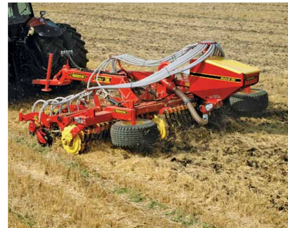
7 Диски, встановлені праворуч і ліворуч на одному ряду, сприяють прямолінійності руху культиватора за трактором
