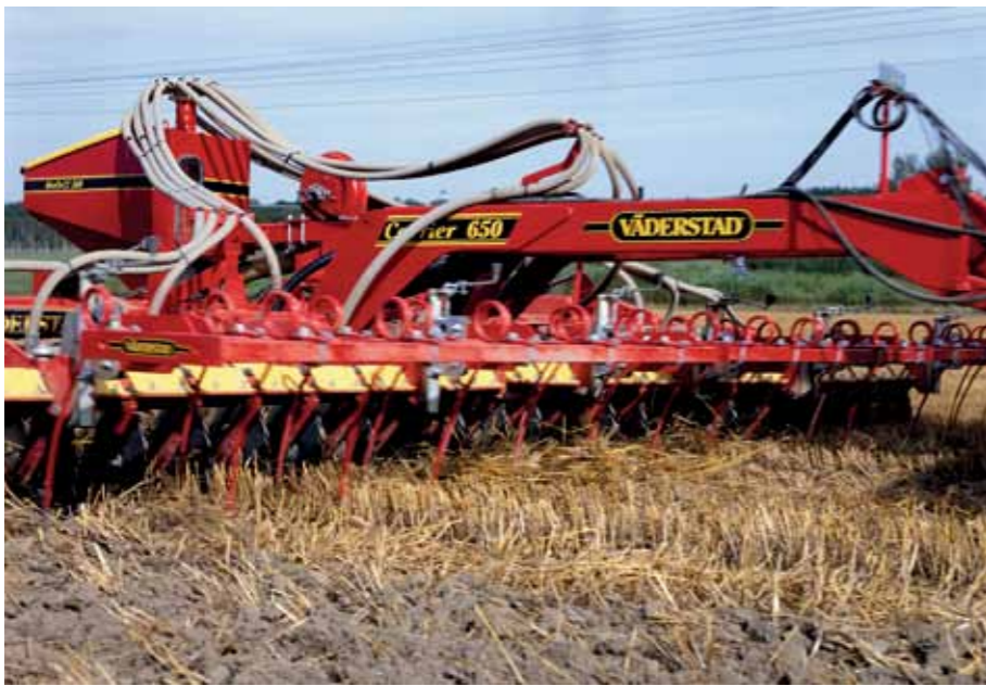
2 Культиватор Carrier 650 з розподільвачем соломи та міні-сівалкою BioDrill 360
