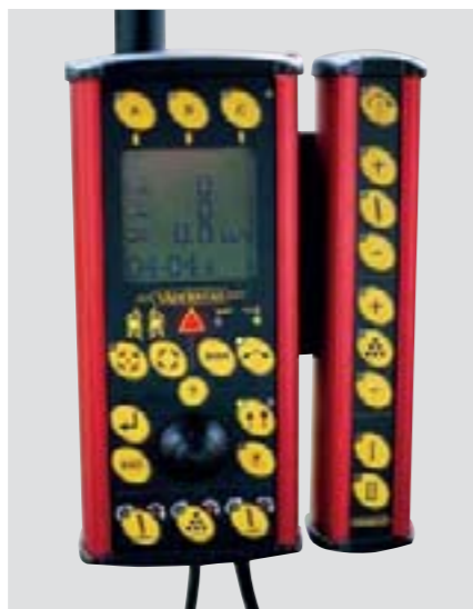
Система автоматизованого контролю забезпечує управління всіма основними і додатковими робочими органами та механізмами сівалки з кабіни трактора
