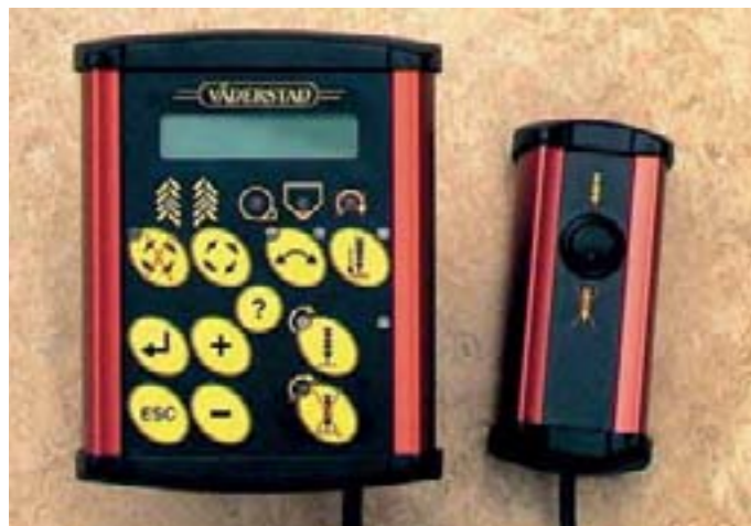
Пульт управління сівалки в кабіні трактора показує засіяну площу, оберти вентилятора, норму висіву та оберти висівної катушки
