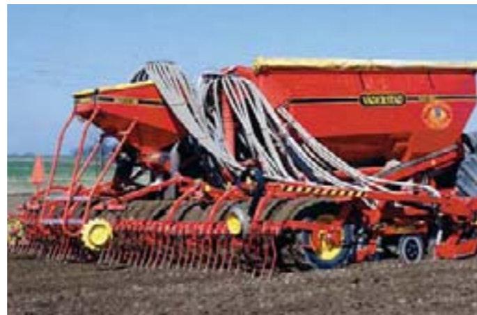
Опція встановлення пневматичної міні-сівалки BioDrill з окремим бункером ємністю 360 літрів на задню стінку основного бункера, призначену для проведення одночасного підсіву багаторічних трав з висівом основної культури
