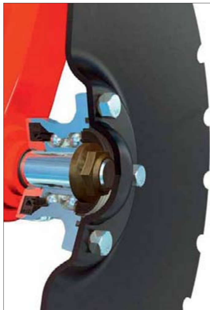
Ступиця диска з дворядним кульковим підшипником та спеціальними герметичними ущільнювачами
