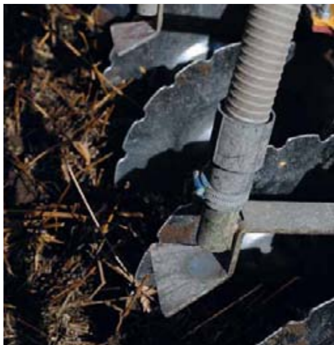
Розподільчі форсунки рівномірно розташовані по всій робочій ширині
