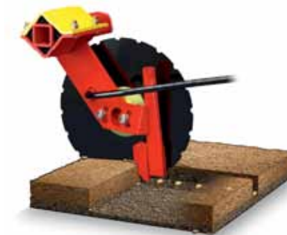
▲ Однією з основних переваг сівалки RapiD є унікальна система контролю глибини під час сівби. Кожне колесо системи прикочування одночасно ущільнює та контролює глибину двох висівних сошників на заданій глибині. Цей процес відбувається безперервно і бездоганно навіть за високої робочої швидкості
