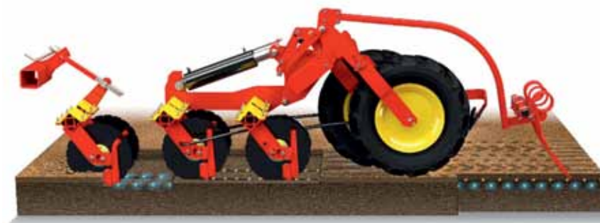
▲ Однією з основних переваг сівалки RapiD є унікальна система контролю глибини під час сівби. Кожне колесо системи прикочування одночасно ущільнює та контролює глибину двох висівних сошників на заданій глибині. Цей процес відбувається безперервно і бездоганно навіть за високої робочої швидкості
