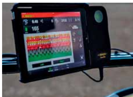
▲ Якщо відбувається відхилення кількості висіваемого насіння від заданих параметрів, система повідомляє про це звуковим сигналом, а «проблемний» сошник позначається на дисплеї червоним кольором
